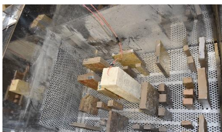
Eprouvettes de lauze calcaire prêtes à subir des cycles de gel/dégel
