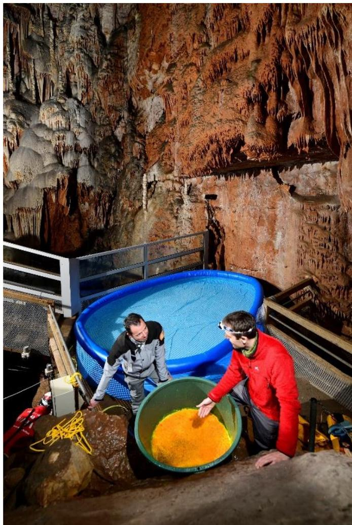
*Figure 19 : Dispositif mis en place pour le traçage de l'aven Armand depuis la plateforme (T13)
