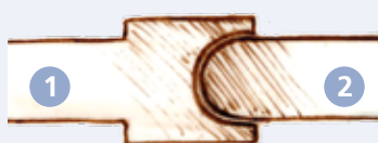
Croquis. système de la « gueule de loup et du mouton ».
