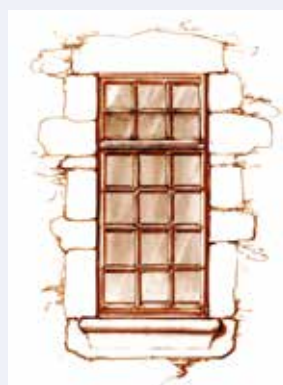
Croquis. Fenêtre à traverse et vitres à petits bois.
