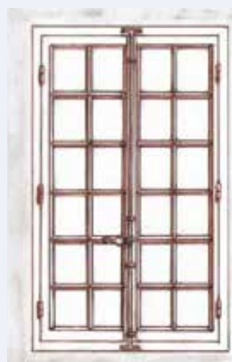
12. Menuiserie ancienne épousant la forme de l'encadrement en arc segmentaire, caractéristique du XVIII e s., à quatorze carreaux par vantail, avec verre étiré ancien (Florac).
