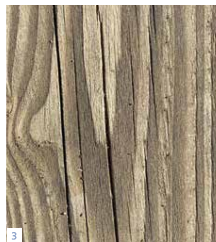
3 Bois moins dense et aux larges veines, le pin tend à se fendre au séchage.
