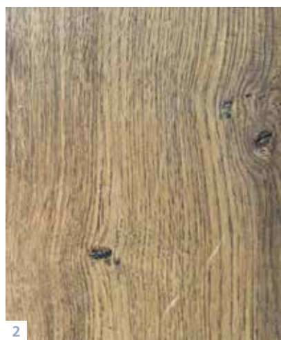
2 Petites stries sombres caractéristiques du veinage serré du chêne.
