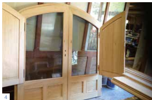
4 Fenêtre cintrée artisanale avec volet intérieur en châtaignier (atelier Mirman, Florac). Loin des modèles de catalogues, sans rapport avec l'identité du territoire, les menuiseries commandées à un artisan local permettent une conception et une pose « sur mesure », ajustées aux irrégularités, et adaptées à la forme et aux dimensions d'un encadrement ancien.
