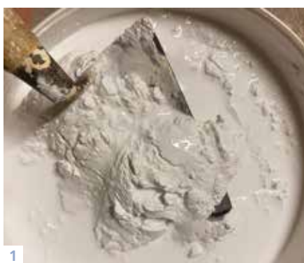
1. Chaux aérienne en pâte, blanc éclatant. 2. Chaux aérienne en poudre, très blanche. 3. chaux hydraulique naturelle, légèrement grisâtre.
