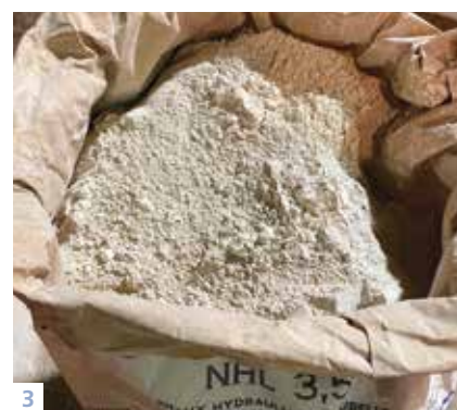
1. Chaux aérienne en pâte, blanc éclatant. 2. Chaux aérienne en poudre, très blanche. 3. chaux hydraulique naturelle, légèrement grisâtre.
