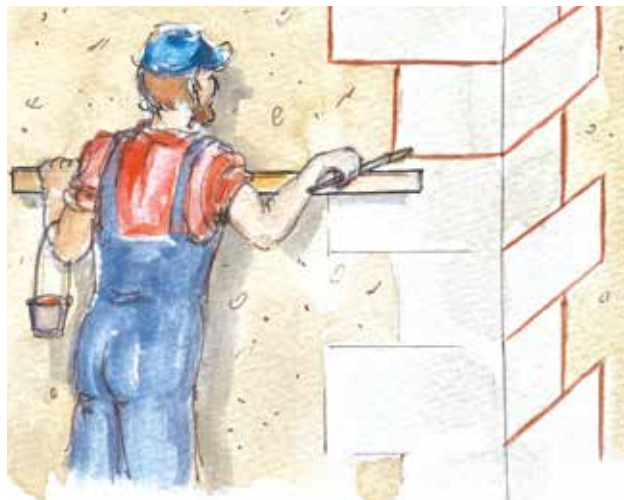
Réalisation d'une chaîne d'angle harpée.
