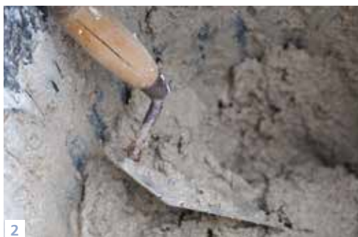
1. Mortier de chaux aérienne en pâte et sable du causse de Sauveterre. 2. Mortier de chaux hydraulique naturelle et sable de schiste.
