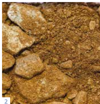
1. Sable roulé de l'Aubrac (granite). 2. Sable de schiste de la carrière de St-Germain de Calberte. 3. Sable calcaire de la carrière des Bondons.
