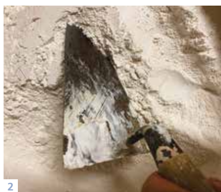
1. Chaux aérienne en pâte, blanc éclatant. 2. Chaux aérienne en poudre, très blanche. 3. chaux hydraulique naturelle, légèrement grisâtre.
