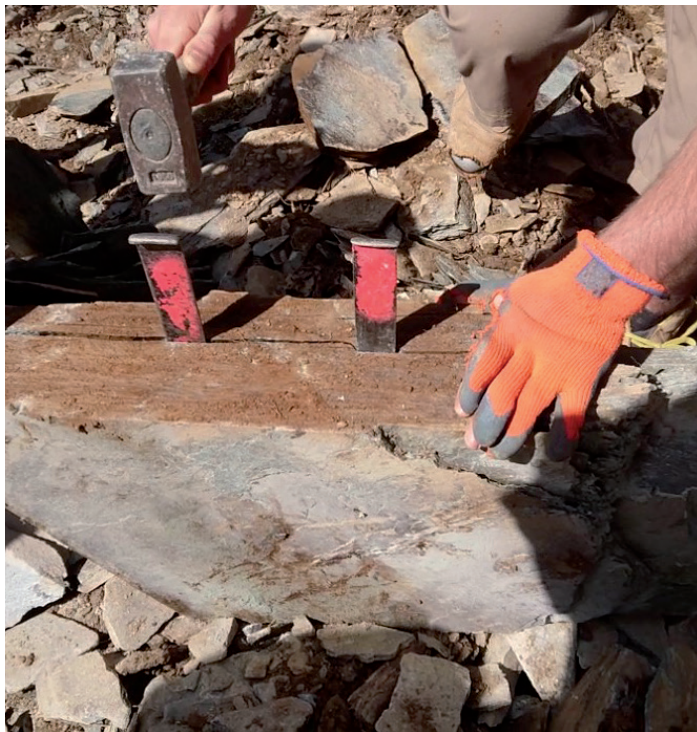
Carrière du Cayrol (12) : clivage des pierres et lauzes prêtes à l'emploi © Eric Dessoliers
