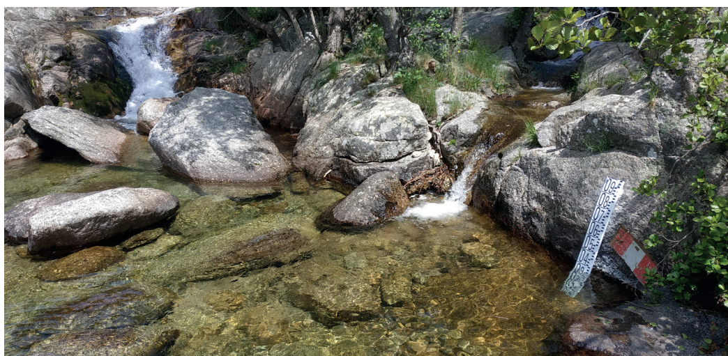
Photo 4. Échelle limnimétrique permettant de mesurer le niveau de la surface de l'eau par rapport à la cote du zéro à l'échelle à destination de la population sur la Gourdouze à Vialas (© Pierre-Alain Ayrat)
