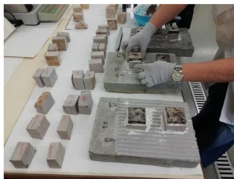
Préparation des échantillons pour l'essai de *pull off* au laboratoire LFC à l'Université de Porto
